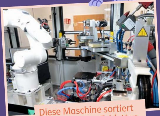
Diese Maschine sortiert mithilfe von KI Tabletten in einem Krankenhaus.
